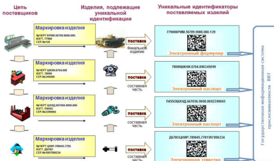
Рисунок 1 – Схема идентификации и маркирования изделий ВВТ в процессе производства
